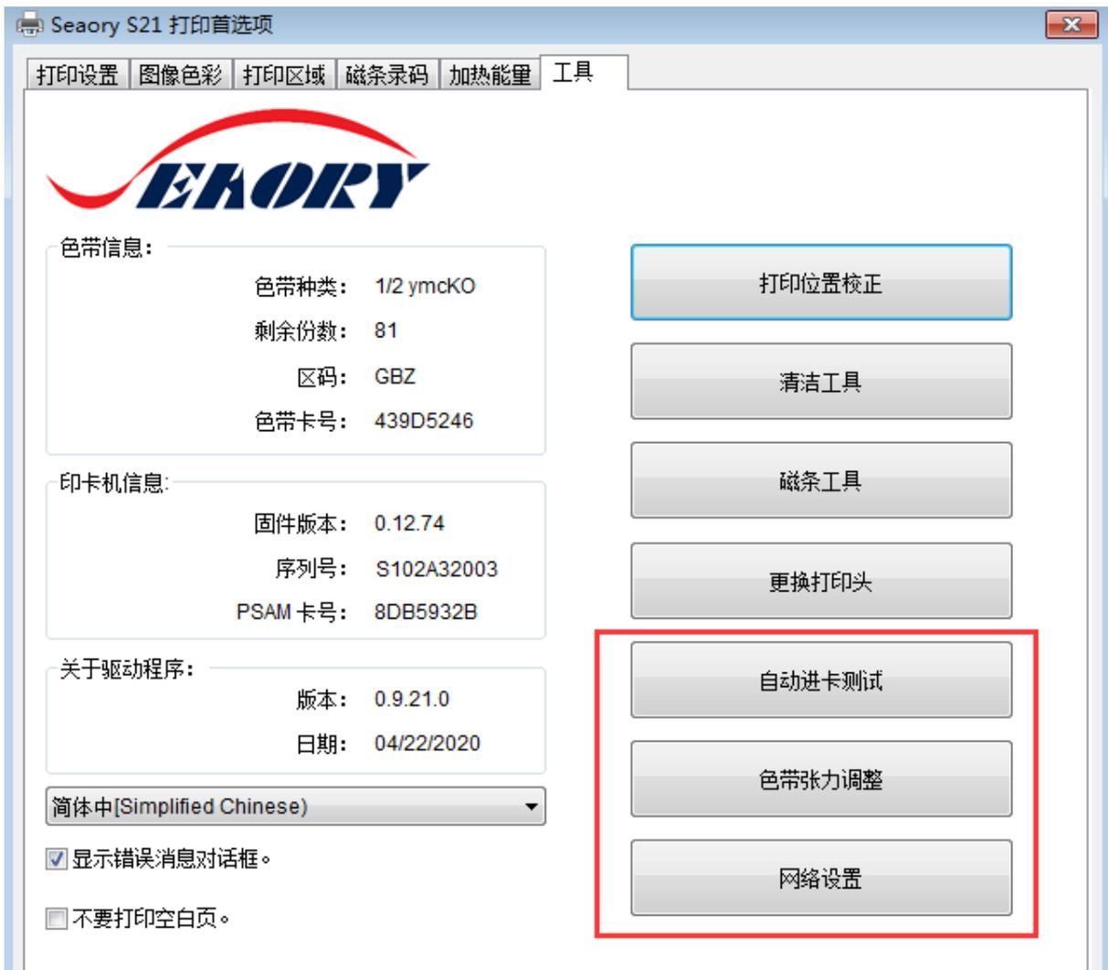
(1) 更换打印头：是指换新的打印头时，在更换打印头对话框中输入新打印头的序列号。
